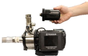
10º Passo - Caso necessário, retire o vaso de expansão para ser calibrado num local diferente da instalação
