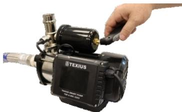
9º Passo - Verifique e ajuste a pressão conforme especificações técnicas do pressurizador.
